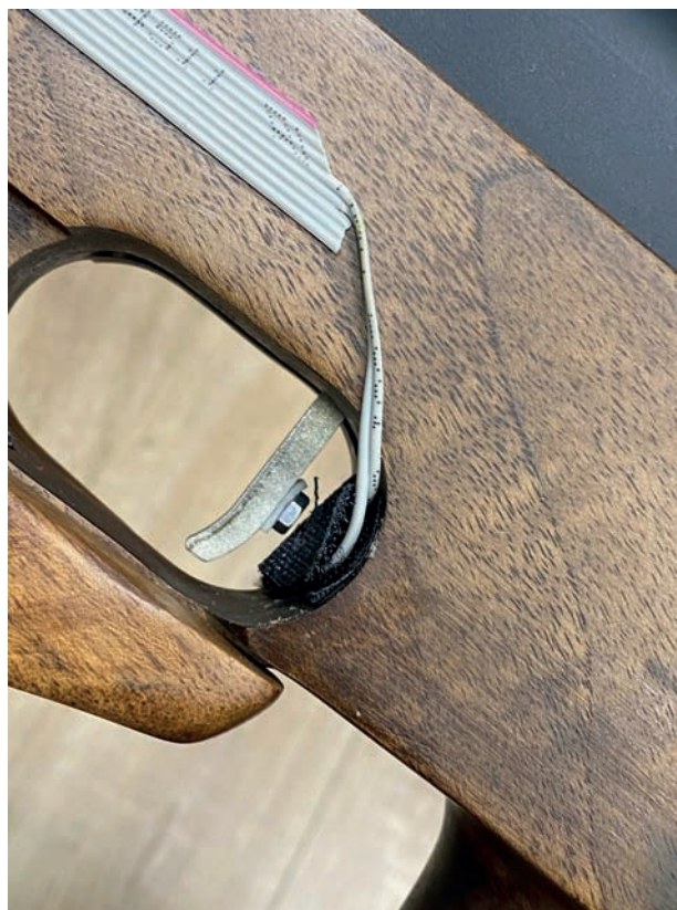
Рисунок 4 Расположение курка и пусковой кнопки на экспериментальной винтовке Figure 4 Location of trigger and firing pin on the experimental rifle
